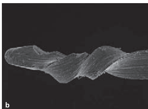
Fig. 4.153 Immagine di un campione di ricerca in cui si è verificata la frattura (freccia), dovuta alla fatica dello strumento Ni-Ti nel punto di massima curvatura del canale.
