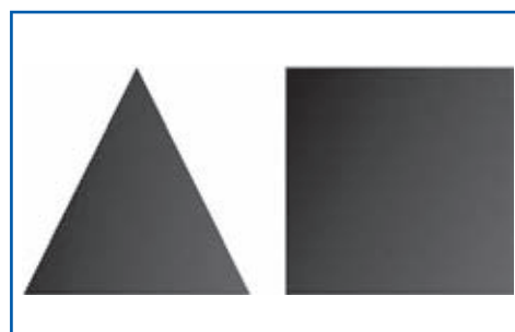
Fig. 4.128 Sezione triangolare del file reamer e quadrata del k-file.
